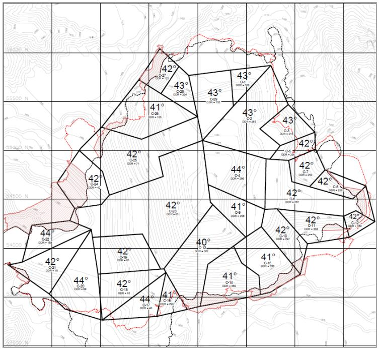
El desarrollo de la mina es en sentido vertical desde la elevación 1800 hasta la elevación 1080 m.s.n.m., con 15 metros de altura de banco, con anchos de caminos de 40 metros y pendientes variables. Los ángulos de talud, caras de banco y anchos de banqueta se determinan a través del estudio geotécnico elaborado por Call & Nicholas Inc. en 2024.
